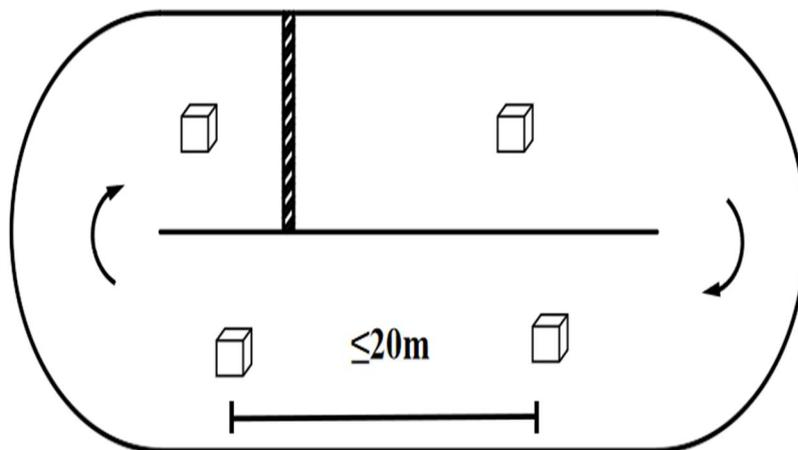
图3 氧化沟工艺点位布设示意图
