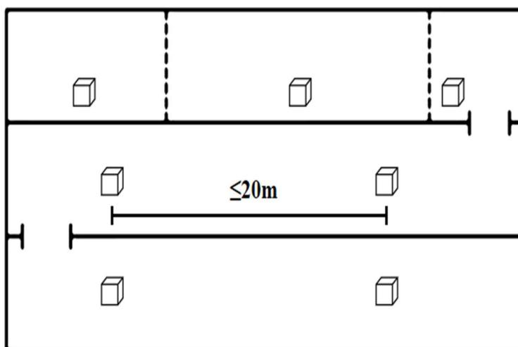
图2 AA0工艺点位布设示意图
